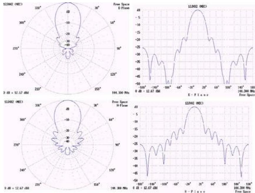
Qui di seguito vengono riportati i valori calcolati dal programma YO 6.52: sono riportati il guadagno, il R.O.S., il rapporto F/B ed impedenza. Forward Gain, SWR, F/B ratio, Impedance, Polar and Rectangular Irradiation diagrams on E and H planes.
